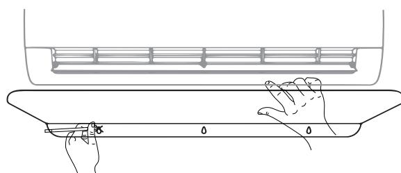
3. При помощи линейки отмерьте расстояние от кондиционера до точки под сверление. Отложите то же расстояние с другой стороны для другого отверстия. Просверлите отверстия по этим точкам. Используйте сверло 6 мм.
